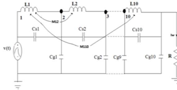
Fig. 5 Ten section lumped parameter model
